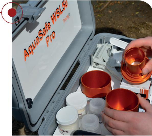
Les Aquasafe® Premium et Pro incluent tous le Photomètre Multiparamètre HydroTest® HT1000. Le HT1000 est un photomètre portable compact mais puissant, léger, qui offre une solution colorimétrique facile au toucher d'un bouton, utilisant de simples comprimés de réactifs.
